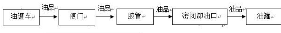
图 2.2-4 柴油卸油工艺流程图
