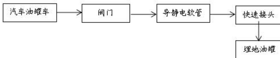
图 2.2-2 接卸柴油油工艺流程图
