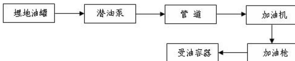
图 2.2-4 柴油加油机加油工艺流程图
