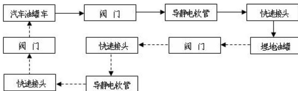
图 2.2-1 接卸汽油工艺流程图
