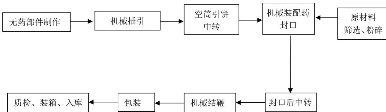
图 2-2：爆竹生产（插引）工艺流程图
