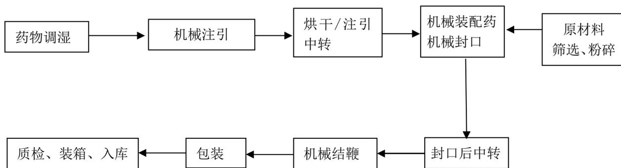
图 2-1：爆竹生产（注引）工艺流程图
