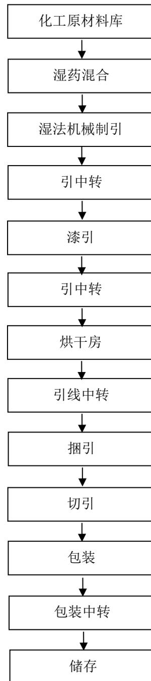
图 2.3-2 纸引（二）生产工艺流程图
