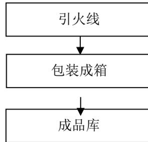
图 2.3-4 旋转类和玩具类（线香型）产品生产工艺流程图
