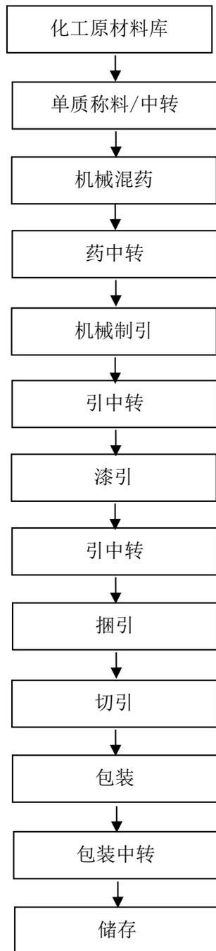
图 2.3-1 安全引（一）生产工艺流程图
