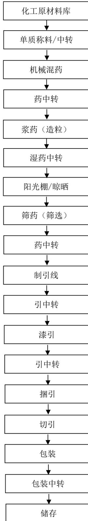
图 2.3-3 安全引（三）生产工艺流程图
