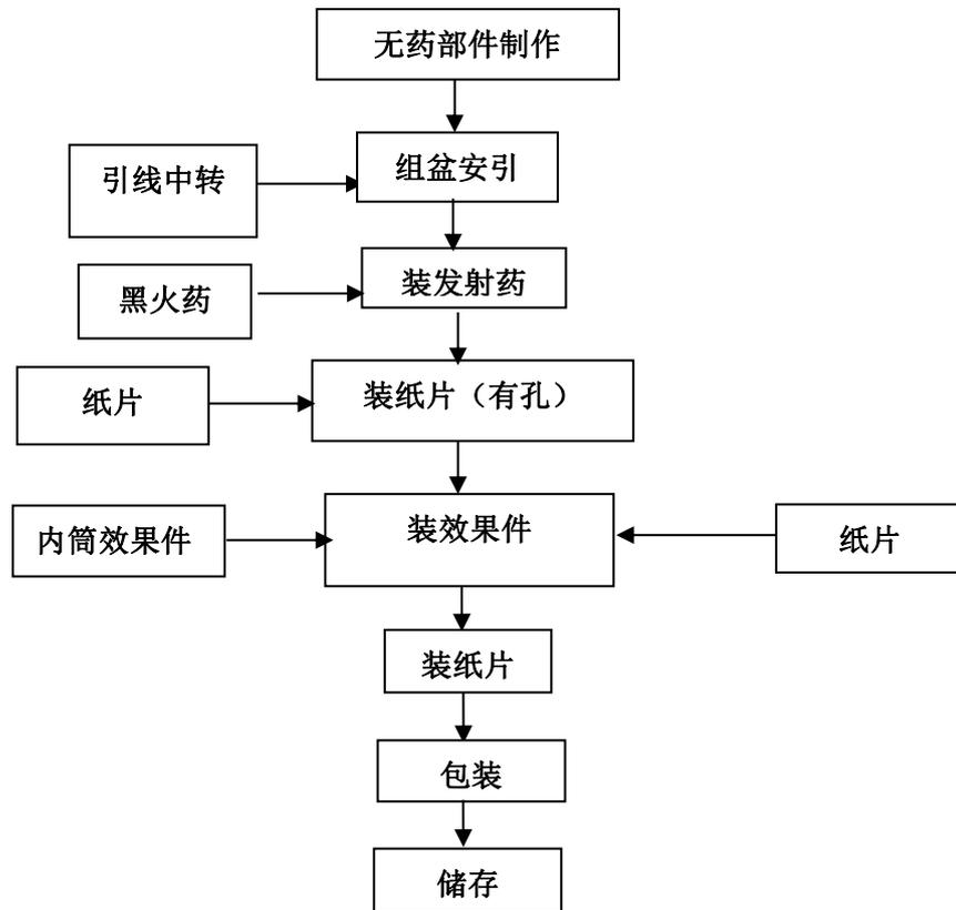
图 2-4-4 组合烟花产品生产工艺流程图
