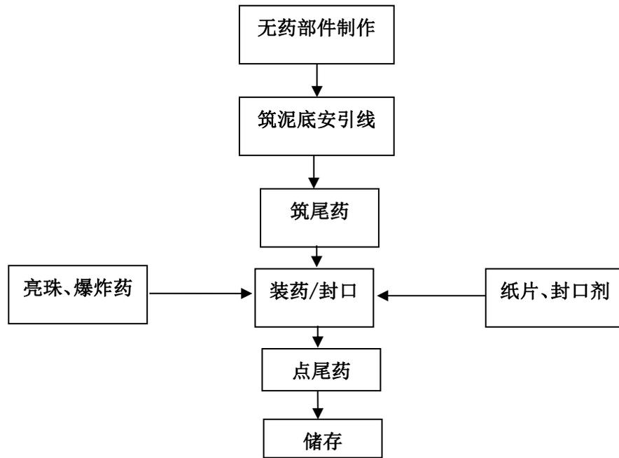
图 2-4-2 效果内筒生产流程图
