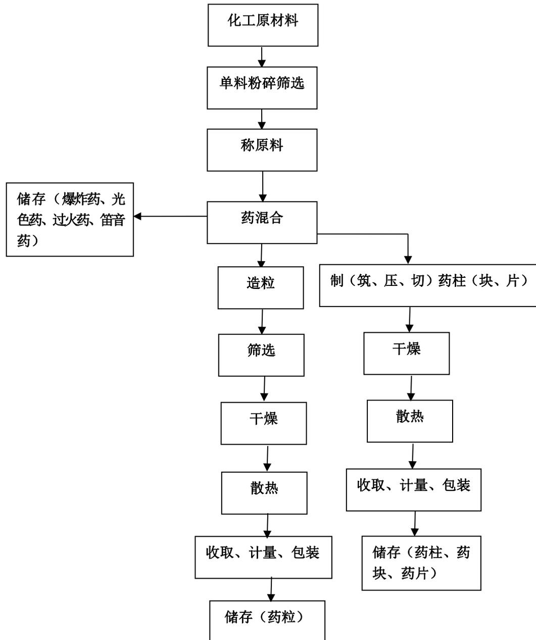
图 2-4-1 药物裸药效果件生产工艺流程图
