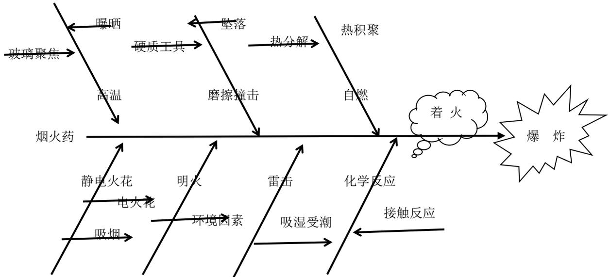
图 3-14-1 烟火药燃烧、爆炸触发条件分析图
