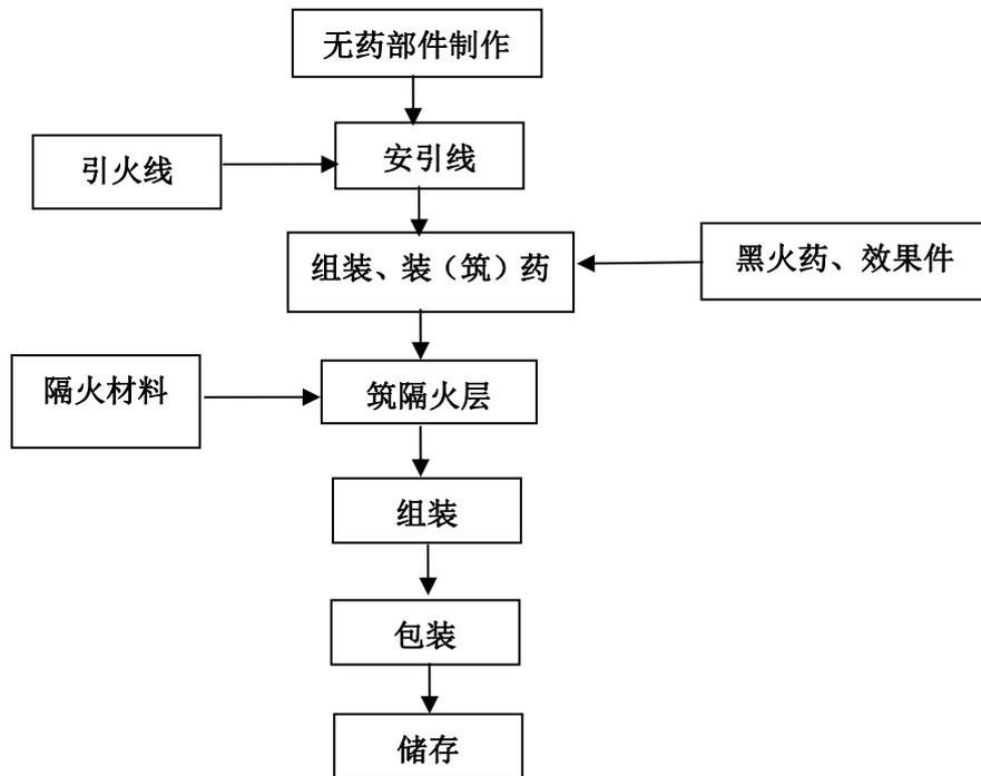
图 2-4-3 吐珠类产品生产工艺流程图
