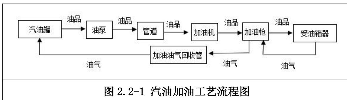
图 2.2-1 汽油加油工艺流程图
