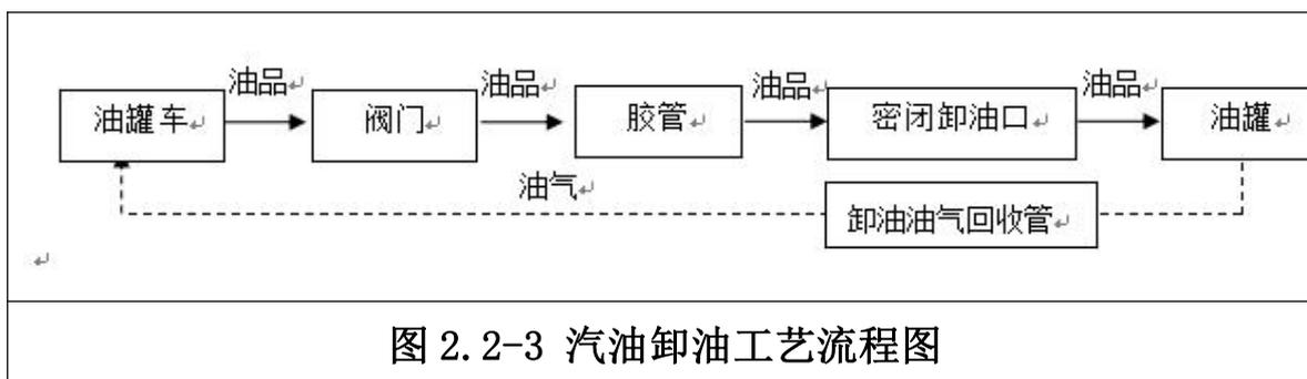
图 2.2-3 汽油卸油工艺流程图
