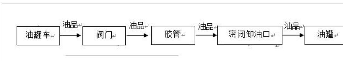
图 2.2-4 柴油卸油工艺流程图
