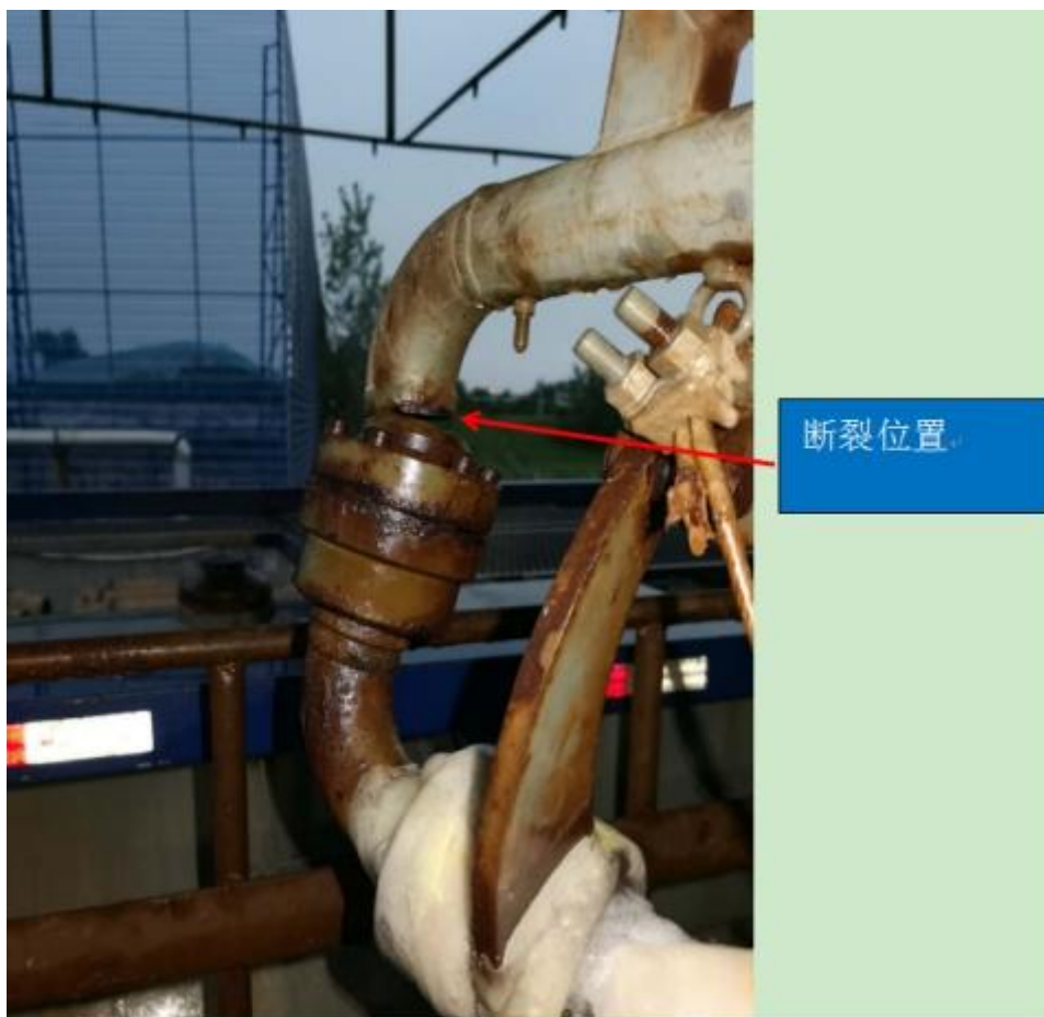
图 6 充装万向节断裂位置图
